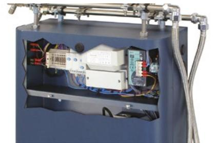
Standardmässig mit Schutzart IP54, wobei alle Innenteile für Betrieb und Wartung leicht zugänglich sind. Die elektrischen Komponenten sind in einem separaten Bereich oberhalb der Wasser- und Luftleitungen untergebracht.
