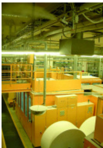
Die dünnen Zellstoffpapier-Lagen reagieren sensibel auf Änderungen der relativen Luftfeuchte
